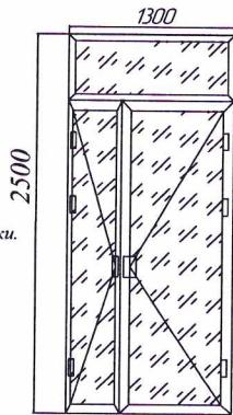
Дверь полуторная + фрамуга: профиль 4-х камерный, ПВХ (2500x1350) - 2 шт.
